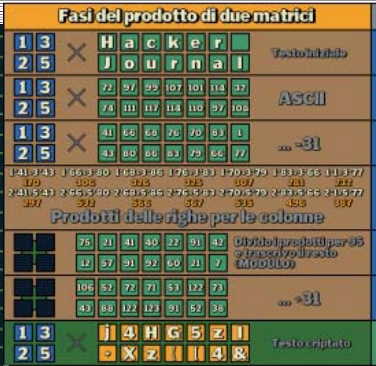
Figura 2: Moltiplicando la matrice chiave per la matrice composta dai codici ASCII del messaggio da cifrare, otteniamo un testo criptato.
