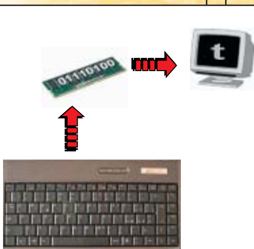
Esempio di codifica in formato binario ad 8 bit (1 byte) di un carattere alfabetico.
