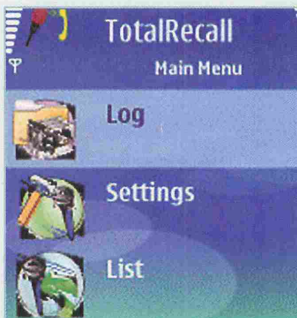
▲ Il menu di TR: in Log impostiamo la modalità di registrazione, in Settings i modi di funzionamento e in List vediamo le registrazioni.
