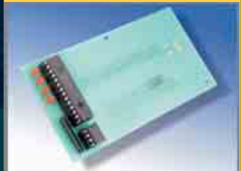
Una scheda PicCard2, con i suoi led di controllo.
