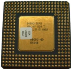
Il processore (chiamato anche CPU, Central Processing Unit o Unità di Elaborazione Centrale, in italiano) è il componente che si occupa del trattamento dei dati.
